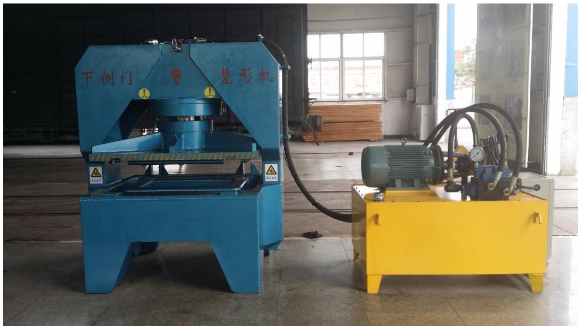
CMTP-1 型货车敞车下侧门调平整形机在丰台车辆段丰西站修所应用现场
