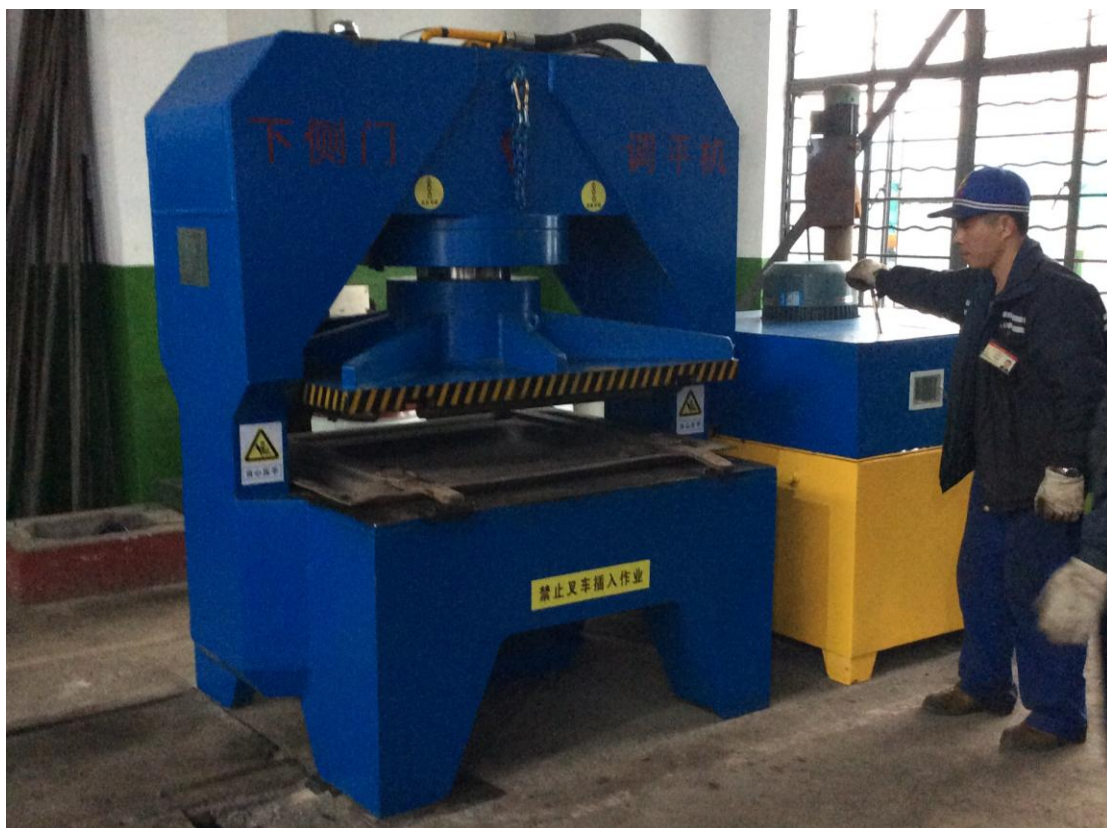
CMTP-1 型货车敞车下侧门调平整形机在杭州北车辆段应用现场
